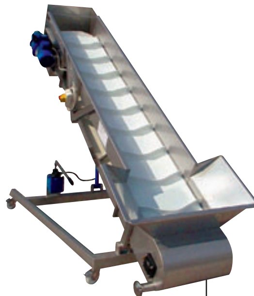
Nastro elevatore ad inclinazione variabile, manovrabile con pistone idraulico comandato con pompa manuale
