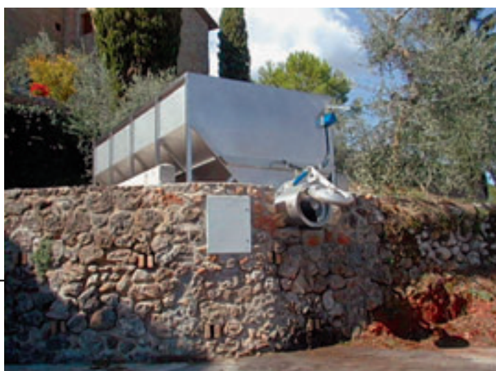
Vasca di ricezione uve con tappo azionato da pompa idraulica manuale
