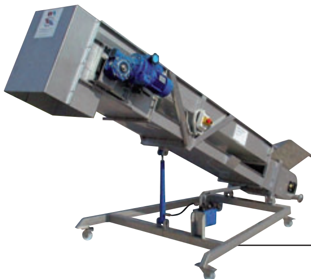
Nastro elevatore ad inclinazione variabile, manovrabile con pistone idraulico comandato con pompa manuale
