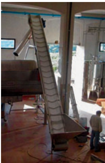
Elevatore a nastro con ralla girevole per carico presse
